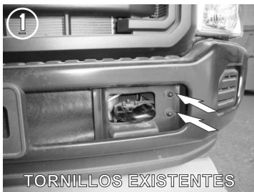
RETIRE PRIMERAMENTE LOS TORNILLOS SUPERIORES
