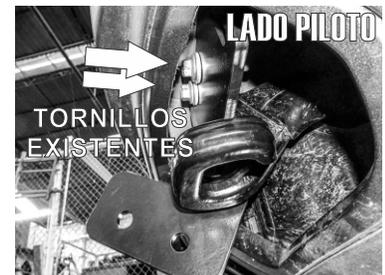
2.- Presente el **Herraje Principal "A"** delante del gancho y posicione los barrenos a la posición de este. Fije el Herraje con los tornillos existentes al gancho haciendo una especie de sandwich con el soporte donde se fija el mismo.
