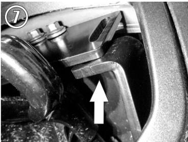
7.- Fije el otro extremo del **Herraje Auxiliar "B"** al barreno lateral del **Herraje Pricipal "A"** con un tornillo de 5/16" X 1 1/4" para un mayor soporte.
