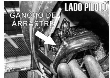
1.- Al frente del vehículo encima de los ganchos de arrastre identifique los tornillos existentes que sujetan a los mismos y proceda a retirarlos. No se deshaga del gancho ya que lo necesitará para el siguiente paso.
