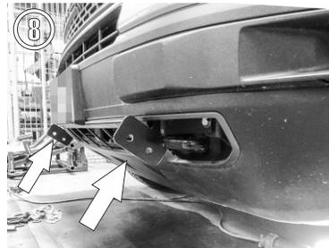
8.- Instale los Herrajes de **Lado Copiloto** de igual forma y finalmente monte la Burrera a estos usando los tornillos 1/2" X 1 1/2".
