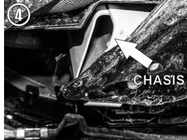
4.- Con los tornillos retirados, jale el plástico para descubrir el orificio señalado en la imagen sobre el chasis del auto.
