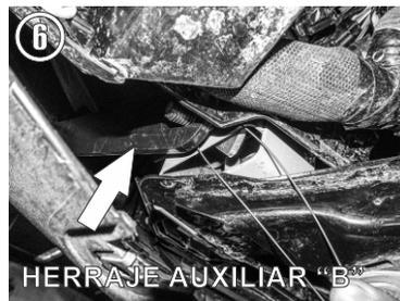
6.- Introduzca el **Herraje Auxiliar "B"** y fíjelo al tornillo puesto en el paso anterior con su tuerca y rondanas de 7/16", tal como se observa.
