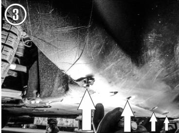
3.- Por la parte inferior del vehículo deberá retirar los tornillos que sujetan la fascia delantera.
