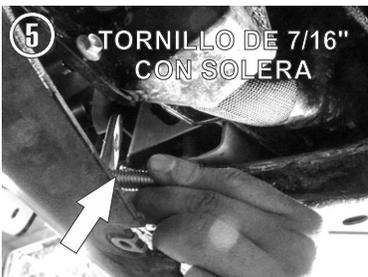
5.- Deberá introducir en el orificio un tornillo de 7/16" X 1 1/2" con solera, de adentro hacia afuera dejando la rosca por la parte externa del chasis.
