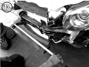
13.- Una vez colocados los herrajes centre y mida la distancia en referencia a la medida interna de las placas de la Burrera Super Bronco a instalar y vuelva a colocar los topes de Poliéstireno recortando la parte donde se instalaron para poder colocar nuevamente en su posición.
