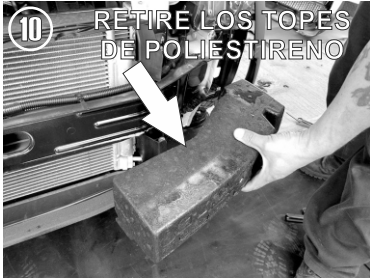
10.- Quite los topes protectores de Poliéstireno del chasis del carro.
