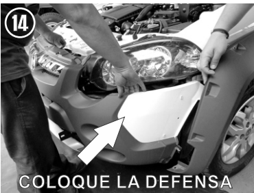
14.- Para poder poner de nuevo la defensa deberá hacer unos pequeños cortes en la parrilla frontal inferior para que puedan pasar los herrajes principales previamente instalados.
