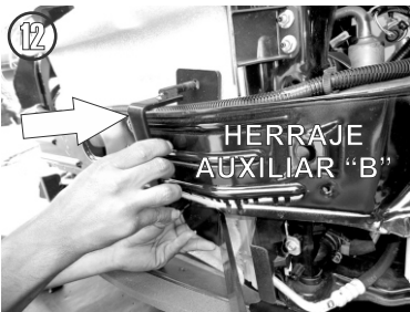
12.- Utilice el Herraje Auxiliar "B" y fíjelo al Herraje principal para sujetarlos al Travesaño a modo de sandwich utilizando las tuercas y rondanas de 3/8". Coloque los herrajes de Lado Copiloto de igual manera.
