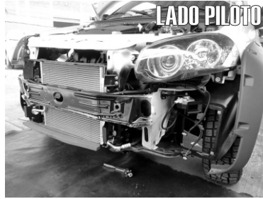
10.- Quite los topes protectores de Poliéstireno del chasis del carro.
