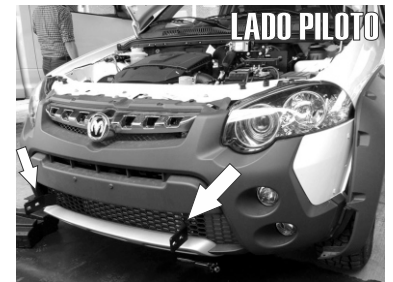
14.- Para poder poner de nuevo la defensa deberá hacer unos pequeños cortes en la parrilla frontal inferior para que puedan pasar los herrajes principales previamente instalados.
