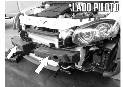
13.- Una vez colocados los herrajes centre y mida la distancia en referencia a la medida interna de las placas de la Burrera Super Bronco a instalar y vuelva a colocar los topes de Poliéstireno recortando la parte donde se instalaron para poder colocar nuevamente en su posición.
