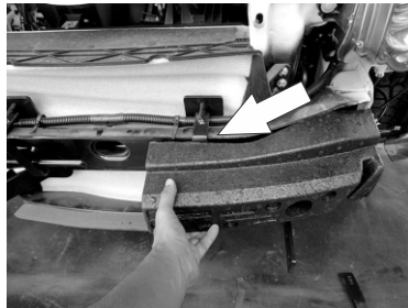
13.- Una vez colocados los herrajes centre y mida la distancia en referencia a la medida interna de las placas de la Burrera Super Bronco a instalar y vuelva a colocar los topes de Poliéstireno recortando la parte donde se instalaron para poder colocar nuevamente en su posición.
