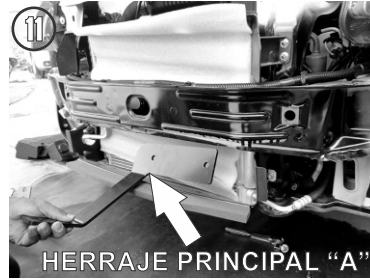
11.- Presente el Herraje Principal "A" e introduzcalo entre el puente transversal y el radiador tal como se muestra en las imágenes.
