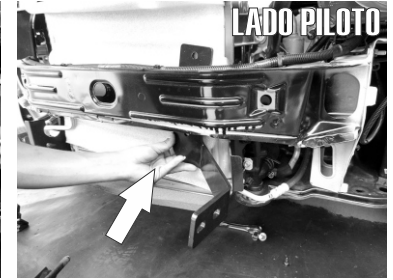
11.- Presente el Herraje Principal "A" e introduzcalo entre el puente transversal y el radiador tal como se muestra en las imágenes.
