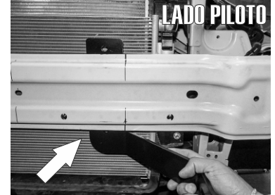
8.- Presente el Herraje Principal "A" e introduzcalo entre el puente transversal y el radiador tal como se muestra en las imágenes.
