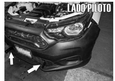
11.- Para poder poner de nuevo la defensa debera hacer unos pequeños cortes en la parrilla frontal inferior para que puedan pasar los herrajes principales previamente instalados.
