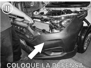
11.- Para poder poner de nuevo la defensa debera hacer unos pequeños cortes en la parrilla frontal inferior para que puedan pasar los herrajes principales previamente instalados.
