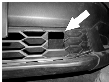
11.- Para poder poner de nuevo la defensa debera hacer unos pequeños cortes en la parrilla frontal inferior para que puedan pasar los herrajes principales previamente instalados.
