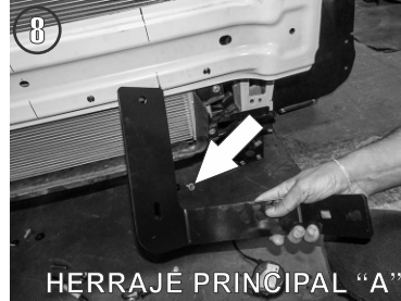
8.- Presente el Herraje Principal "A" e introduzcalo entre el puente transversal y el radiador tal como se muestra en las imágenes.
