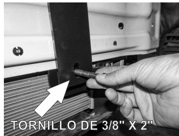
9.- Utilice el Herraje Auxiliar "B" con un Tornillo de 3/8" X 2" en el barreno superior y fijelo al Herraje principal para sujetarlos al Travesaño a modo de sandwich utilizando un tornillo más de 3/8" X 2" para la parte inferior. Coloque los herrajes de Lado Copiloto de igual manera.
