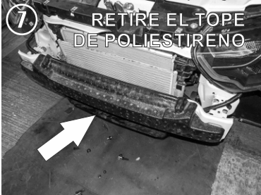
7.- Quite el tope frontal protector de Poliestireno del chasis del carro.
