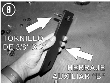
9.- Utilice el Herraje Auxiliar "B" con un Tornillo de 3/8" X 2" en el barreno superior y fijelo al Herraje principal para sujetarlos al Travesaño a modo de sandwich utilizando un tornillo más de 3/8" X 2" para la parte inferior. Coloque los herrajes de Lado Copiloto de igual manera.
