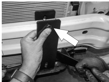
9.- Utilice el Herraje Auxiliar "B" con un Tornillo de 3/8" X 2" en el barreno superior y fijelo al Herraje principal para sujetarlos al Travesaño a modo de sandwich utilizando un tornillo más de 3/8" X 2" para la parte inferior. Coloque los herrajes de Lado Copiloto de igual manera.
