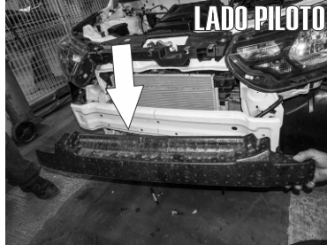
7.- Quite el tope frontal protector de Poliestireno del chasis del carro.
