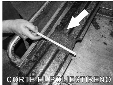
10.- Una vez colocados los herrajes centre y mida la distancia en referencia a la medida interna de las placas de la Burrera Super Bronco a instalar y vuelva a colocar los topes de Poliestireno recortando la parte donde se instalaron para poder colocar nuevamente en su posición.
