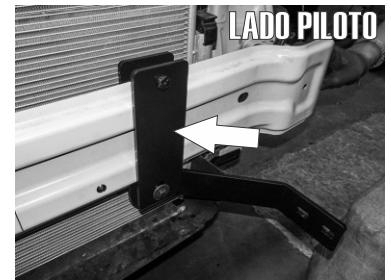
9.- Utilice el Herraje Auxiliar "B" con un Tornillo de 3/8" X 2" en el barreno superior y fijelo al Herraje principal para sujetarlos al Travesaño a modo de sandwich utilizando un tornillo más de 3/8" X 2" para la parte inferior. Coloque los herrajes de Lado Copiloto de igual manera.
