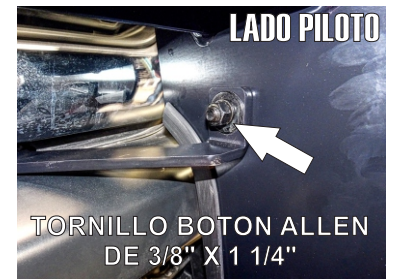
15.- Una vez puestos lo Herrajes, presente, alinee y fije la burrera a estos usando tres Tornillos Cab. Hex. de 1/2" X 1 1/2" para el Herraje principal y un Tornillo Cab. Botón Allen de 3/8" X 1 1/4" para el auxiliar.
