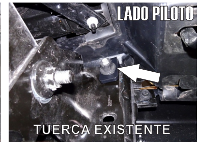
14.- Proceda a insertar el Herraje Auxiliar "B" sobre el resaque cortado en la defensa y montelo en la parte interna sobre el tornillo que retiró la tuerca. Use la misma tuerca existente para fijar el herraje.
