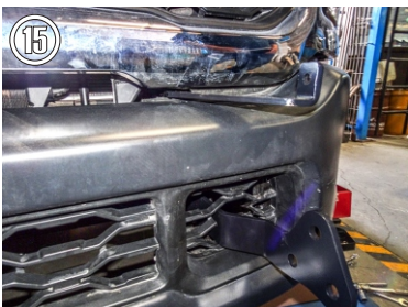
15.- Una vez puestos lo Herrajes, presente, alinee y fije la burrera a estos usando tres Tornillos Cab. Hex. de 1/2" X 1 1/2" para el Herraje principal y un Tornillo Cab. Botón Allen de 3/8" X 1 1/4" para el auxiliar.
