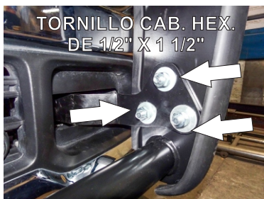
16.- Una vez puestos lo Herrajes, presente, alinee y fije la burrera a estos usando tres Tornillos Cab. Hex. de 1/2" X 1 1/2" para el Herraje principal y un Tornillo Cab. Botón Allen de 3/8" X 1 1/4" para el auxiliar.
