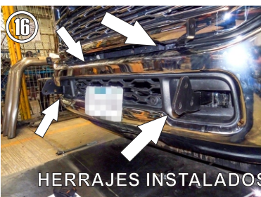
16.- Una vez puestos lo Herrajes, presente, alinee y fije la burrera a estos usando tres Tornillos Cab. Hex. de 1/2" X 1 1/2" para el Herraje principal y un Tornillo Cab. Botón Allen de 3/8" X 1 1/4" para el auxiliar.
