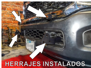
15.- Una vez puestos lo Herrajes, presente, alinee y fije la burrera a estos usando tres Tornillos Cab. Hex. de 1/2" X 1 1/2" para el Herraje principal y un Tornillo Cab. Botón Allen de 3/8" X 1 1/4" para el auxiliar.
