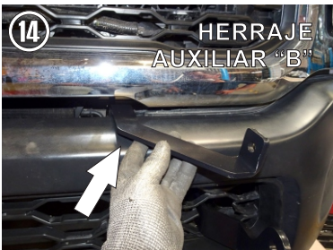
14.- Proceda a insertar el Herraje Auxiliar "B" sobre el resaque cortado en la defensa y montelo en la parte interna sobre el tornillo que retiró la tuerca. Use la misma tuerca existente para fijar el herraje.
