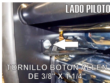
16.- Una vez puestos lo Herrajes, presente, alinee y fije la burrera a estos usando tres Tornillos Cab. Hex. de 1/2" X 1 1/2" para el Herraje principal y un Tornillo Cab. Botón Allen de 3/8" X 1 1/4" para el auxiliar.
