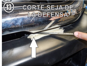
13.- Deberá hacer un corte en la seja interna de la defensa frontal. Tal como se observa en las imágenes.
