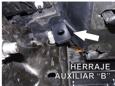
14.- Proceda a insertar el Herraje Auxiliar "B" sobre el resaque cortado en la defensa y montelo en la parte interna sobre el tornillo que retiró la tuerca. Use la misma tuerca existente para fijar el herraje.
