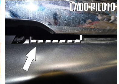
13.- Deberá hacer un corte en la seja interna de la defensa frontal. Tal como se observa en las imágenes.
