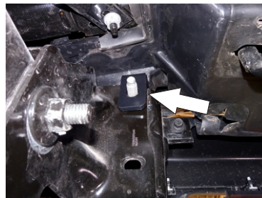
14.- Proceda a insertar el Herraje Auxiliar "B" sobre el resaque cortado en la defensa y montelo en la parte interna sobre el tornillo que retiró la tuerca. Use la misma tuerca existente para fijar el herraje.
