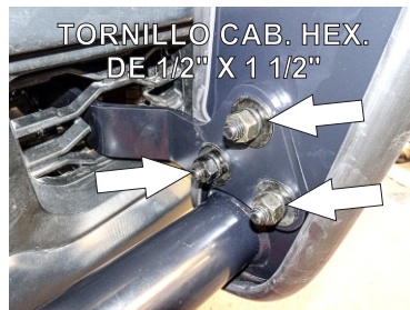
15.- Una vez puestos lo Herrajes, presente, alinee y fije la burrera a estos usando tres Tornillos Cab. Hex. de 1/2" X 1 1/2" para el Herraje principal y un Tornillo Cab. Botón Allen de 3/8" X 1 1/4" para el auxiliar.
