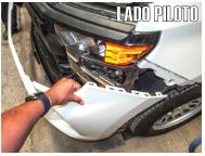
2.- Ahora por la parte del salpicadero identifique y retire los tornillos señalados en la imagen. Por la parte superior interna del cofre, a la altura del salpicadero ubique los tornillos existentes los cuales deberá aflojar para retirar la facia delantera, safandola de las grapas que la sujetan, tal como se muestra.
