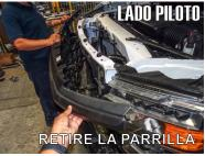
3.- Luego, retire el tornillo que sujeta la parrilla frontal señalado en la foto para después retirarla con cuidado safandola de las grapas que la sujetan.
