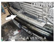
**14.-** Ubique el tornillo existente en la parte frontal superior de la defensa y proceda a retirarlo. Posteriormente para instalar la ventila retirada en el Paso 4, deberá hacer un recorte tal como se observa a la altura del tornillo retirado y vuelvala a colocar en su lugar.
