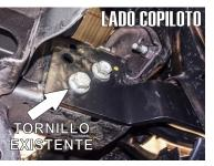
12.- Introduzca el Herraje Principal "A" y fijelo usando los tornillos existentes retirados con anterioridad.
