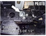
9.- Inserte otro tornillo pasado de 1/2" X 5", usando una rondana especial calibre 3/16", y del otro lado fijelo con una solera cuadrada de 1/4", junto con sus rondanas y tuerca de 1/2".
