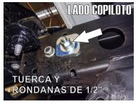
13.- Inserte otro tornillo pasado de 1/2" X 5", usando una rondana especial calibre 3/16", y del otro lado fijelo con una solera cuadrada de 1/4", junto con sus rondanas y tuerca de 1/2".
