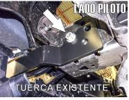
8.- A un costado del gancho, en el chasis, retire la tuerca del tornillo existente que sujeta al mismo gancho. Introduzca el Herraje Principal "A" y fijelo al mismo tornillo, usando la tuerca retirada.
