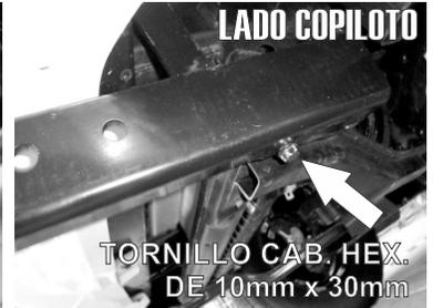
3.- Una vez descubierta la zona inferior retire el tornillo existente que se señala en las imágenes y presente el **Herraje Auxiliar "A"** y fíjelo con un Tornillo Cab. Hex. de 10mm X 30mm retirado con anterioridad poniendo una Rondana especial a modo de calza.
