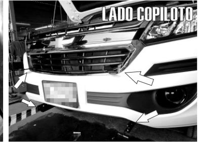
9.- Fije ambos herrajes auxiliares en el segundo barreno posterior usando un Tornillo Cab. Hex. de 7/16" X 1 1/2" instalando tanto el lado piloto como el copiloto de igual manera.
