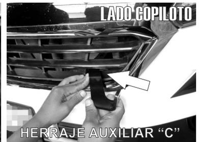
7.- Ahora inserte de lado a lado del chasis sobre el Herraje Principal y el Auxiliar un Tornillo Cab. Hex. de 3/8" X 3 1/2".
