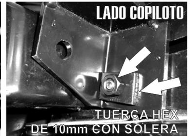
6.- Una vez recortado el plástico de cada lado inserte el **Herraje Auxiliar "B"** tal como se ilustra sujetandolo sobre el Tornillo existente en el chasis y colocandole la solera avellanada y la Tuerca Hex. de 10mm.
