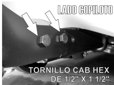
10.- Finalmente monte la Burrera Super Bronco y fijela a los Herrajes usando un Tornillo Cab. Botón Allen de 3/8" X 1 1/4" para la parte superior y dos Tornillos Cab. Hex. de 1/2" X 1 1/2" para la parte inferior.
