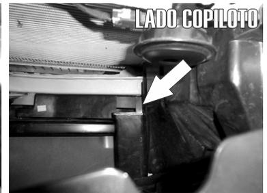
4.- Termine de fijarlo al chasis con otro Tornillo Cab. Hex. de 10mm X 30mm en el segundo barreno del Herraje.
