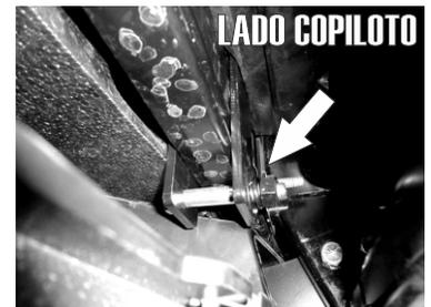
6.- Fije a modo de sandwich los **Herrajes "C" y "D"** con el travesaño usando un Tornillo Hex. de 1/2" x 3" para los barrenos inferiores sin apretar aun para poder mover los Herajes según lo necesiten al montar la Burrera.
