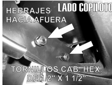
8.- Teniendo ya los herrajes puestos de lado Piloto y Copiloto presente la Burrera y sujétela con los Tornillos Cab. Hex. de 1/2" X 1 1/2" para el Herraje inferior y un Tornillo Cab. Botón Allen de 3/8" X 1 1/4" para el Herraje superior. Finalmente todos los tornillos y tuercas para una correcta instalación.
