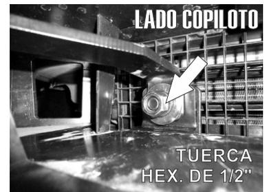
7.- Luego retire las Tuercas y Rondanas del Tornillo superior de los **Herrajes "C" y "D"** e Introduzca y agregue el **Herraje Auxiliar "B"** fijandolo nuevamente con las Tuercas y rondanas retiradas de 1/2".
