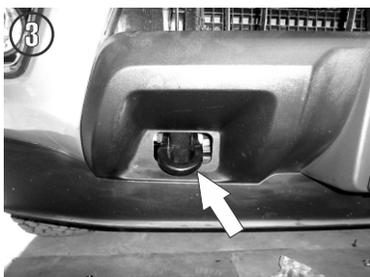
3.- Una vez retiradas las tolvas plásticas proceda a retirar los ganchos laterales sujetos al chasis del vehículo desatornillando los dos Tornillos largos que lo fijan a este y sacando los Ganchos hacia el frente.
