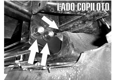
4.- Ya quitados los Ganchos del chasis proceda a instalar los **Herrajes Principales "A"** en el mismo sitio de lado lateral exterior usando dos Tornillos de 1/2" x 3".
