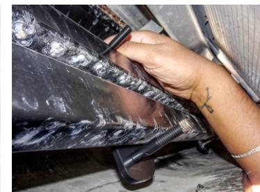
2.- Introduzca en la abertura entre la fascia y el radiador el **Herraje Auxiliar "B"**, poniendolo sobre el travesaño, dejando la rosca con dirección al radiador tal como se observa. Sitúelo al extremo del travesaño.
