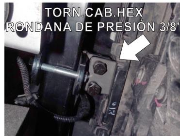
7.- Coloque el **Herraje Aux. "D"** a la altura del **Herraje Aux. "B"**, verifique que ambos barrenos de cada herraje coincidan uno con otro. Ahora donde retiro la **Tolva Central**, introduzca la mano por el interior y guíe la **Rondana de Presión** y el **Tornillo Cab.Hex** de 3/8", para fijar no en su totalidad los **Herrajes Aux.** tanto **Lado Copiloto/Piloto**.
