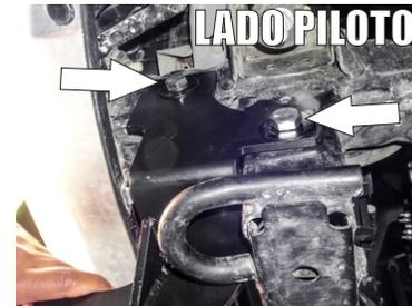
8.- Ahora presente el **Herraje Principal "A"** al lateral del chasis por la parte inferior, por encima del gancho de arrastre, y fíjelo a la estructura del vehículo usando dos tornillos pasados de 1/2 X 3 1/2".
