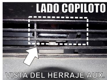
5.- Una vez que retiro la **Tolva Central**, verifique la posición del **Herraje Aux. "B"** por el interior entre el panel y el radiador del vehículo tanto **Lado Piloto/Copiloto**, como se observa en la imagen.
