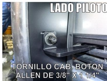
9.- Finalmente monte la Burrera a los herrajes instalados y fíjela a estos usando tornillos de 1/2" X 1 1/2" para la parte inferior y los tornillos cab. boton allen de 3/8" para la parte superior.
