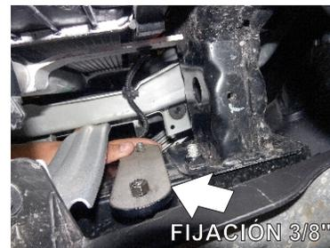
3.- Enseguida coloque el **Herraje Aux. "C"** para complementar la fijación correcta del **Herraje Aux. "B"** observe las imágenes y replique la misma instalación del **Lado Copiloto**. finalice colocando las Rondana Plana, de presión y tuerca hexagonal de 3/8", para fijar no en su totalidad. ya que debe dejarle un poco de juego para montar la burrera y al final fijar en su totalidad.
