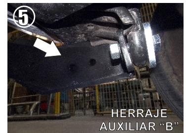
4. LADO COPILOTO PLACA, TORN. Y RONDANA PLANA
