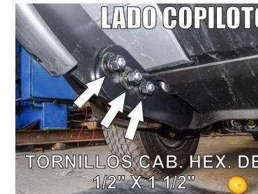
9.- Una vez insertados los Tornillos Especiales "T" instale el Herraje Principal "A" (Lado Piloto) y sujetelo a los tornillos con las tuercas y rondanas de 7/16"
