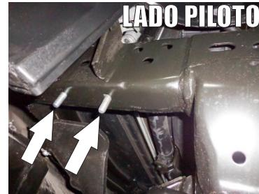
8.- Introduzca de igual forma otro Tornillo Especial "T" en el segundo barreno inferior del chasis con la guia de Micro-Alambre.
