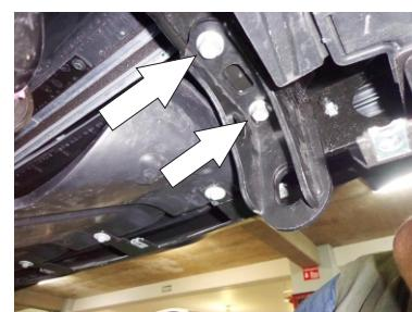
4.- Una vez retirada la tolva ubique el gancho de arrastre y retirelo quitando los dos Tornillos existentes que lo sujetan al chasis.
