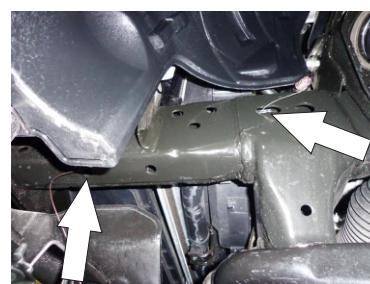
7.- Para instalar el Herraje del lado Piloto deberá insertar el Tornillo Especial "T" de 7/16" X 1 1/2" con ayuda de la Guia de Micro-Alambre pasando desde el barreno lateral del chasis al inferior tal como se ilustra en las fotos.
