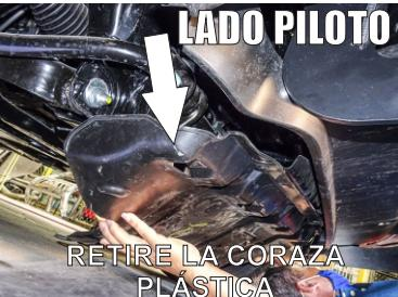
1.- Ubique la coraza inferior de la carrocería y proceda a quitarla retirando todos los tornillos y grapas que la sujetan.
