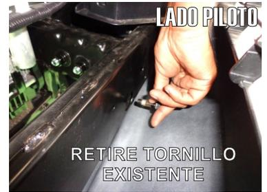
6.- Ya que quito la tolva retire el Tornillo existente que esta ubicado en el travesaño frontal del auto usando la matraca.
