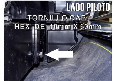
8.- Una vez puesto el Herraje Auxiliar "C" fijelo con un Tornillo Cab. Hex. de 10mm X 60mm en el lugar donde retiro el Tornillo existente con anterioridad.
