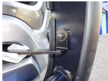
9.- Ya puestos los Herrajes Piloto y Copiloto de igual forma, proceda a instalar la Burrera Super Bronco sujetandola con los Tornillos de 1/2" X 1 1/2" para la parte inferior (Herrajes Principales) y con los Tornillos Cab. Boton Allen de 3/8" X 1 1/4" para la parte superior (Herrajes Auxiliares).
