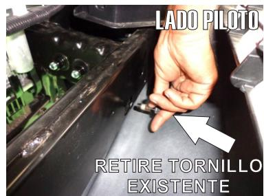
4.- Levante el cofre del vehículo y retire la tolva superior quitando las grapas plásticas con el desarmador plano.
