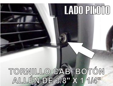
8.- Ya puestos los Herrajes Piloto y Copiloto, presente la Burrera por fuera de los Herrajes Principales “A” y fíjela con los Tornillos de 1/2" X 1 1/2" y en la parte superior fije los Herrajes Auxiliares “B” con la Burrera utilizando los Tornillos Cab. Botón Allén de 3/8" X 1 1/4" .
