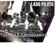
3.- Introduzca el Herraje Principal "A" de lado externo del chasis y fijelocon tres Tornillos Cab. Hex. de 1/2" X 3 1/2" con sus respectivas Rondanas y tuercas de 1/2".
