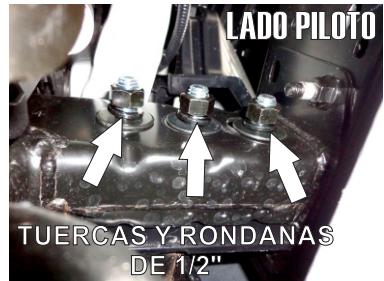
3.- Introduzca el Herraje Principal “A” de lado externo del chasis y fíjelo con tres Tornillos Cab. Hex. de 1/2" X 3 1/2" con sus respectivas Rondanas y tuercas de 1/2".
