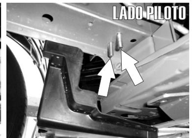
3.- De igual forma ayudandose con la Guía de Micro-Alambre inserte otro Tornillo Esp. con Varilla soldada de 5/16" X 1" en el barreno aledaño.
