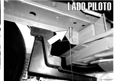
2.- Ahora ubique los barrenos que se encuentran en el parte inferior del chasis lateral e inserte con ayuda de una Guía de Micro-Alambre un Tornillo Esp. con Varilla soldada de 5/16" X 1" en uno de los barrenos frontales tal como muestran las imágenes.
