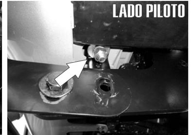
9.- Coloque y fije el Herraje Auxiliar "B" tanto del tornillo Esp. "T" insertado en el paso anterior tal como se observa en las fotografías.
