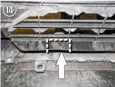
14.- Para volver a poner la defensa frontal en su lugar, se sugiere hacer unos recortes a la altura de los Herrajes auxiliares instalados, de tal manera que el plástico no quede presionado a estos.
