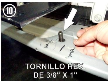
10.- A la altura de los Herrajes instalados, en la estructura inferior de la carrocería identifique los barrenos existentes e inserte a estos, dos tornillos hex. de 3/8" X 1", dejando la rosca hacia arriba.
