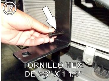
12.- Fije ambos Herrajes en los barrenos coincidentes con un tornillo hex. de 3/8" X 1 1/4".
