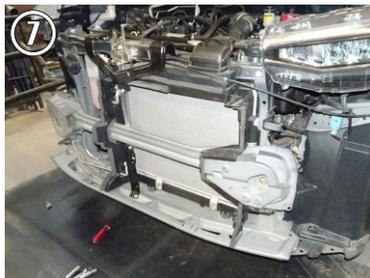
7.- Ya descubierta la parte frontal del auto, marque el centro en el travesaño frontal, delante del radiador, y marque en referencia al centro, una distancia de 43 cm hacia los lados.
