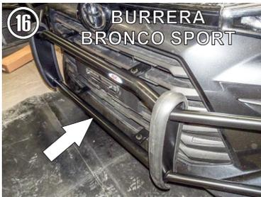
16.- Presente y file la **Burrera Bronco Sport** a los Herrajes instalados, usando los tornillos de 3/8" x 1 1/4" con sus respectivas tuercas y rondanas.
