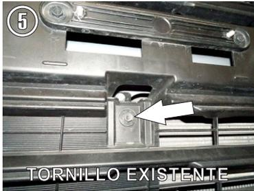
5.- Una vez retirada la placa frontal, retire el tornillo que descubierto en esa zona.
