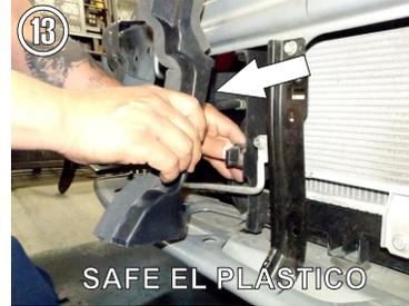
13.- De lado Copiloto deberá safar el plastico divisor del radiador para poder instalar correctamente el **Herraje Auxiliar "B"** (lado Copiloto). Al final vuelva a poner el plástico en su lugar. Alinee y apriete todos los Herrajes en su posición.
