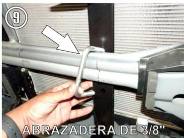
9.- Use las abrazaderas incluidas en la tornillería para sujetar el Herraje al travesaño frontal, pasandolas de frente hacia atrás y usando las tuercas y rondanas de 3/8". Instale de igual manera el Herraje del otro lado (Copiloto).
