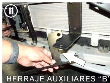
11.- Con los tornillos insertados en la estructura, presente y fije a estos, el **Herraje Auxiliar "B"**, usando las tuercas y rondanas de 3/8"
