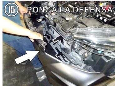
15.- Vuelva a poner la defensa en su posición, usando las respectivas grapas y tornillos retirados al principio.
