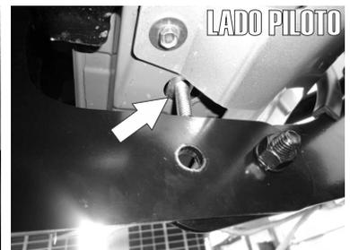
6.- Termine de fijar el Herraje con un Tornillo Cab. Hex. de 6mm X 25mm.
