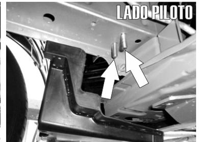
3.- De igual forma ayudándose con la Guía de Micro-Alambre inserte otro Tornillo Esp. con Varilla soldada de 5/16" X 1" en el barreno aledaño.
