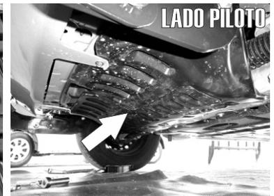
10.- Termine de Fijar el **Herraje Auxiliar "B"** como al Herraje Principal junto con el Bumper con un Tornillo Cab. Hex. de 1/2" X 1 1/2".
