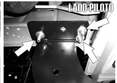
4.- En el barreno señalado inserte otro Tornillo Esp. con Varilla soldada de 5/16" X 1".
