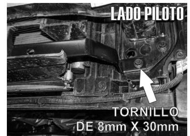
6.- Retire el tornillo frontal inferior señalado para presentar y fijar a este barreno el **Herraje Auxiliar "C"** usando un tornillo de 8mm X 30mm, dejando el otro extremo por la parte recortada del plástico.
