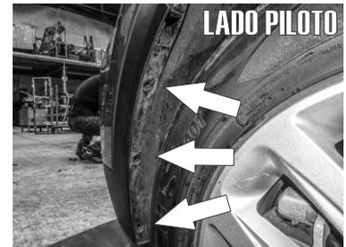
1.- Abra el cofre del vehículo y retire las grapas que sujetan la fascia en la parte superior. Por los costados, de lado del salpicadero, retire tanto el tornillo que sujeta la fascia por la parte superior, como también las grapas señaladas en las imágenes.
