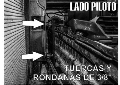
7.- Pase el **Herraje Principal "A"** por detrás del travesaño frontal, dejando el brazo de agarre hacia adelante del mismo y fijelo a modo de sandwich usando el **Herraje Auxiliar "B"** junto con dos tornillos de 3/8" X 2 1/2", tal cual se muestra.
