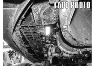
2.- Identifique las grapas y tornillos existentes por debajo de la carrocería que sujetan la tolva inferior y quitelos para finalmente retirala completamente.
