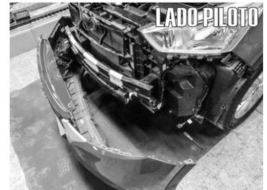
3.- Ya una vez retirados los tornillos y grapas que sujetan la facia delantera del vehiculo deberá jalarla con precaución para desanclar la pieza por debajo de los faros. **NOTA; Asegurese de desenchufar los faros o sensores sujetos a esta facia.**
