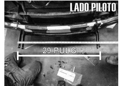
8.- Cuide de alinear los barrenos de ambos Herrajes ("A" y "B") para agarrarse con un tornillo de 3/8" X 1 1/4". Una vez puesto los herrajes de ambos lados asegúrese que midan 29 pulg. por la parte externa del brazo y apriételes firmemente.
