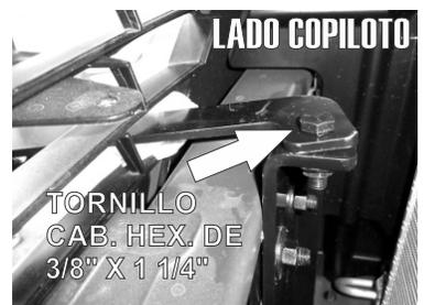
4.- Del lado frontal de la parrilla del Auto inserte el **Herraje Auxiliar "D"** en la rendija señalada y fijelo sobre el Herraje Principal montado usando el Tornillo Cab. Hex. de 3/8" X 1 1/4".
