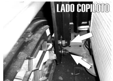
4.- Por la parte inferior de la parrilla frontal instale el **Herraje Auxiliar "C"** al Herraje Principal usando dos Tornillos Cab. Hex. de 3/8" X 1 1/4" entre las rendijas señaladas.
