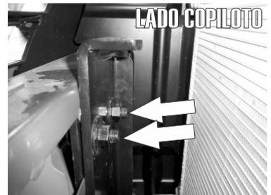
3.- Ahora Introduzca de igual forma el **Herraje Principal "A"** entre el Radiado y el Travesaño del vehiculo para fijarlo con el Herraje previamente instalado a modo de sandwich usando las tuercas y rondanas de 3/8"
