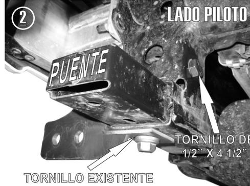
2.- Enseguida presente el Herraje Principal "A" sobre el puente transversal y fijelo por debajo con el tornillo existente y por enfrente con el tornillo de 1/2" X 4 1/2".
