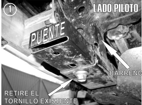
1.- Identifique el puente transversal por debajo del vehículo y retire el tornillo existente con la llave de 17mm .
