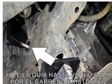
6.- Una vez que salio la Guía por el Barreno Existente 1, proceda a insertar sobre uno de los barrenos de la solera la Guía, enseguida enrosque el **Tornillo Esp. Hex. c/Varilla de 3/8" x 1 1/2"**, sobre la guía como se muestra en la imagen y despues introduzca sobre el Barreno Existente 1 la solera y el tornillo, hasta hacerlo llegar al Barreno Existente 2.
