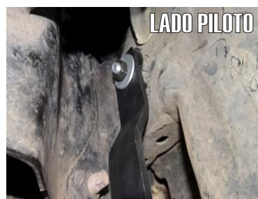
**6.- NOTA: NO RETIRE LA GUÍA DEL TORNILLO ESPECIAL. YA QUE LE AYUDARA A FIJAR EL AUXILIAR "B".**
