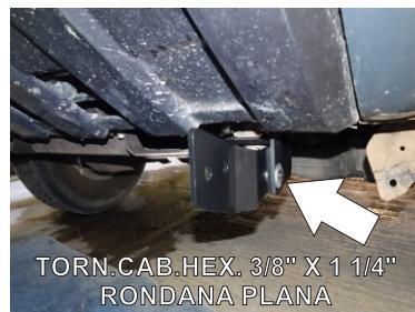
12.- Una vez puestos ambos Herrajes "A" y "B", proceda a verificar que coincidan los barrenos señalados en la imagen y comience colocando el Tornillo Cab.Hex. de 3/8" x 1 1/4", con sus respectivas Rondanas Planas, de Presión y Tuerca Hexagonal de 3/8".
