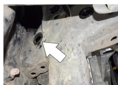
4.- Una vez ubicado el brazo del chasis proceda a retirar los plásticos existentes que están señalados, utilice un desarmador plano para que sea mas fácil retirarlos.
