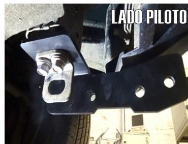
11.- Coloque la Solera y el Gancho de Arrastre que retiro al inicio haciendo un tipo Sandwich entre las piezas y los Herrajes Principales y vuelva a colocar los Tornillos Existentes que retiro al inicio.
