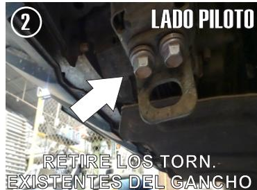
2.- Al retirar el faldón del vehículo, se observara el gancho de arrastre en el lado Copiloto. y del lado Piloto una solera dobrada el cual debe de retirar.
