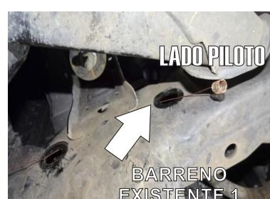
5.- Introduzca la Guía Micro-Alambre para tornillo de 3/8", por el barreno existente de donde retiro el plástico 2 y hagalo llegar hasta el barreno existente de donde retiro el plástico 1.
