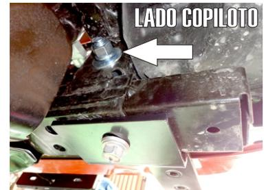
5.- Inserte un segundo Tornillo Cab. Hexagonal de 1/2" X 4 1/2" en el barreno superior del Herraje y atravesándolo al chasis. Use las tuercas y rondanas de 1/2" para terminar de fijarlo.
