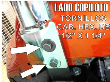
7.- Ya colocados los Herrajes (Piloto y Copiloto) instale la Burrera Alfa G-H fijandola con los Tornillo Cab. Hex. de 1/2" X 1 1/4".
