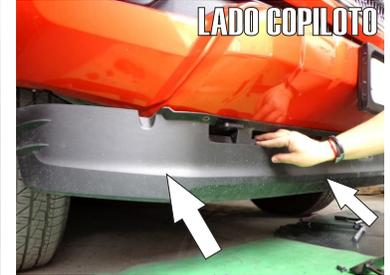
6.- Ahora tendrá que hacer los cortes necesarios para volver a poner la Tolda plástica retirada en el primer paso para continuar con la instalación.
