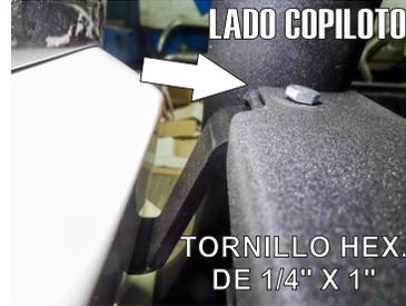
9.- Ya puestos los Herrajes Piloto y Copiloto de igual forma, proceda a instalar la Burrera Alfa Bronx Black 01 sujetandola con los Tornillos de 1/2" X1 1/2" con los Herrajes Principales, con sus respectivas Rondanas y Tuercas. Y con los Tornillos de 1/4" X 1" para la parte superior (Herrajes Auxiliares "B") igual con sus respectivas Rondanas y Tuercas.
