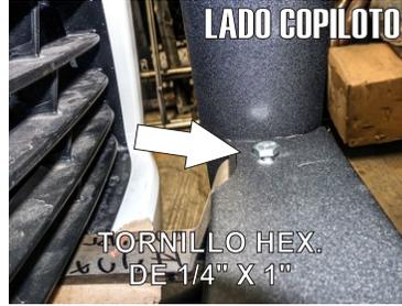
9.- Ya puestos los Herrajes Piloto y Copiloto de igual forma, proceda a instalar la Burrera Alfa Bronx Black 01 sujetandola con los Tornillos de 1/2" X1 1/2" con los Herrajes Principales, con sus respectivas Rondanas y Tuercas. Y con los Tornillos de 1/4" X 1" para la parte superior (Herrajes Auxiliares "B") igual con sus respectivas Rondanas y Tuercas.
