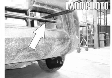
9.- Arme el Herraje Auxiliar "B" junto con el Herraje Auxiliar "C" y un Tornillo Cab. Hex. de 5/16" X 2 1/2" como se muestra en la primer imagen y coloquelo en el puente transversal que está entre el Radiador y la Parrilla de la defensa sacandolo por la primer rendija superior.
