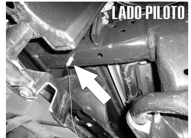
6.- Para instalar el Herraje del lado Piloto deberá insertar el Tornillo Especial "T" de 7/16" X 1 1/2" con ayuda de la Guía de Micro-Alambre pasando desde el barreno lateral del chasis al inferior tal como se ilustra en las fotos.
