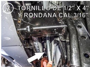
2.- Ubique el chasis por debajo del vehículo e inserte un Tornillo de 1/2" X 4" con rondana Esp. Calibre 3/16" de 1/2" por el barreno que está a un costado, al lado del barreno roscado, y de adentro hacia la parte externa atravesando el chasis, tal como se ve en las imágenes.
