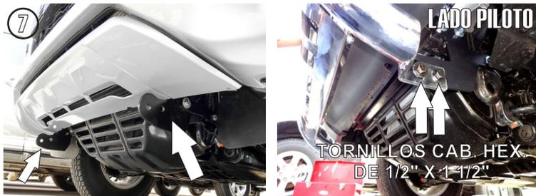
7.- Una vez instalados los Herrajes de ambos lados; presente e instale la Burrera a los Herrajes usando los Tornillos de 1/2" X 1 1/2".
