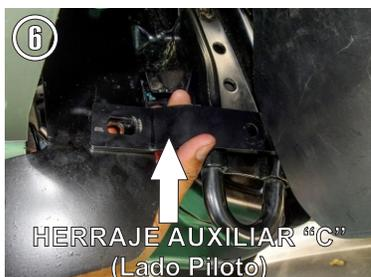
6.- Para el Lado Copiloto también use el Herraje Auxiliar "C" (Lado Piloto) para reforzar el Herraje principal "A" fijandolo al gancho de arrastre con un Tornillo Cab. Hex. de 3/8" X 2" y con un Tornillo Cab. Hex. de 3/8" X 1 1/4" al Herraje. (El Galuz va hacia el Herraje Principal).
