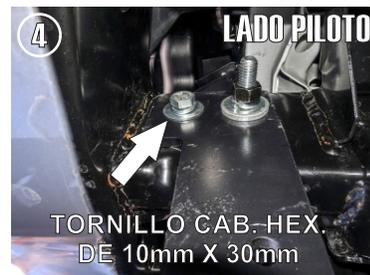
4.- Una vez fijado el Herraje inserte el Tornillo de 10mm X 30mm en el barreno roscado aledaño.
