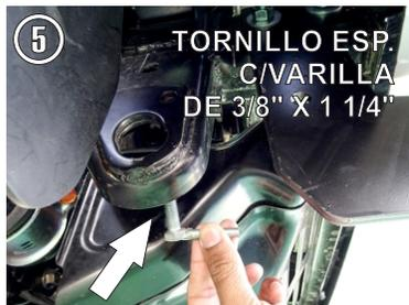
5.- Use el Herraje Auxiliar "C" (Lado Copiloto) para reforzar el Herraje principal "A" fijandolo al gancho de arrastre, esta vez con un Tornillo Esp. con varilla soldada de 3/8" X 1 1/4" insertandolo por la parte interna del gancho tal como se observa y con un Tornillo Cab. Hex. de 3/8" X 1 1/4" al Herraje. (El Galuz va hacia el Herraje Principal).
