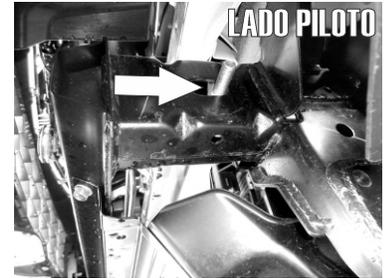
1.- Identifique en la parte frontal inferior del auto el barreno existente en el chasis señalado en las imágenes superiores y proceda a insertar un Tornillo Esp. "T" dejando la rosca hacia fuera tal como se observa.
