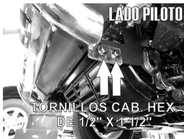
5.- Instale el Herraje Principal de lado Copiloto de la misma forma y presente e instale la Burrera a los Herrajes usando los Tornillos de 1/2" X 1 1/2".
