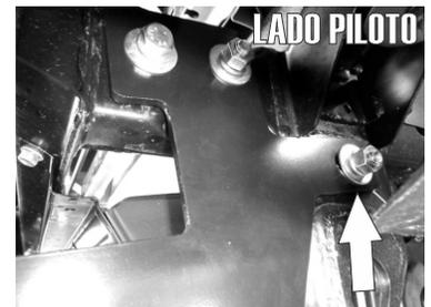
4.- Por el gancho que está soldado al chasis proceda a insertar un Tornillo Especial "T" de 7/16" X 1 1/2" y termine de fijarlo al Herraje con las rondanas y tuerca de 7/16".
