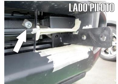
8.- Inserte un Tornillo especial "T" Cab. Hex. de 3/8" X 1 1/4" en el travesaño arriba del chasis en dirección del herraje instalado y presente el Herraje Auxiliar "B" en ese sitio tal como se muestra en las últimas dos imágenes de este paso. Fíjelo con las Rondanas y Tuercas de 3/8"
