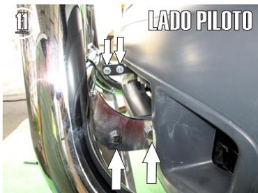
11.- Para finalizar presente la Burrera Alfa G-H y sujetela con los Tornillos Cab. Hex. de 1/2" x 1 1/2" y las Rondanas de 1/2".
