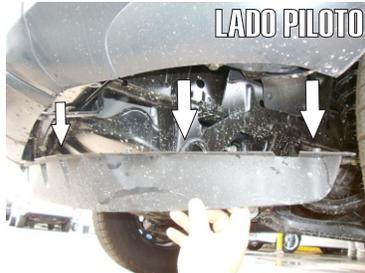
1.- Identifique en la parte inferior de la defensa el plástico protector y proceda a retirarla removiendo todos los tornillos que la sujetan.
