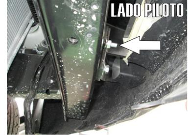
7.- De nuevo por la parte interna del chasis inserte el tornillo especial "T" Cab. Hex. de 5/16" X 1 1/2" sacando la rosca del tornillo por la parte frontal de la defensa y el Herraje Principal "A", fíjelo con las Rondanas y Tuercas de 5/16
