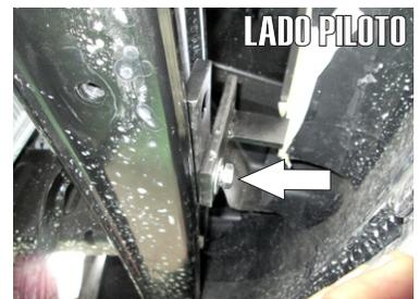
6.- Introduzca el Herraje Principal "A" (lado piloto) por la parte frontal de la defensa torciendolo un poco de manera que entre por la rendija inferior, fijelo al varreno que esta en el chasis con el Tornillo Cab. Hex. de 10mm X 45mm
