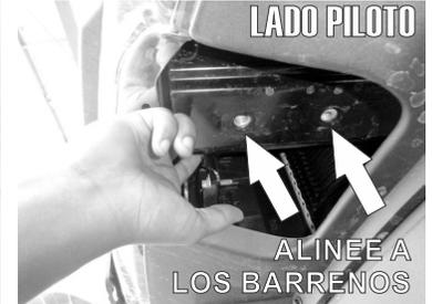
7.- Inserte el Herraje Auxiliar "B" manualmente por dentro del chasis y alineandolo con los barrenos existentes.
