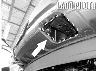
6.- Si el vehículo no cuenta con ganchos de arrastre deberá hacer un corte en la parte inferior de la defensa marcada en la imagen para descubrir el chasis y proceder con la instalación.
