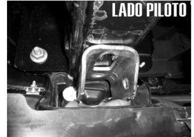
2.- Retire los tornillos que sujetan los ganchos con el chasis ayudandose de la matraca y la extensión larga hasta quitar por completo los dos tornillos.
