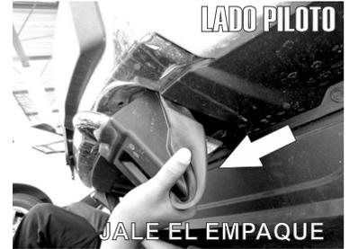
1.- Identifique los ganchos de arrastre por debajo del vehículo y retirelos de la forma siguiente; Meta la mano por debajo del vehículo hasta la parte interna de la defensa y presione el empaque-tapón que rodea al gancho y jalelo hacia abajo.
