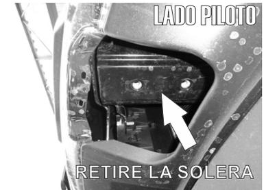
3.- Quite el gancho de arrastre y el empaque-tapón jalandolos hacia bajo de la defensa y centre manualmente la solera con los barrenos del chasis como se muestra en las fotografías anexas.
