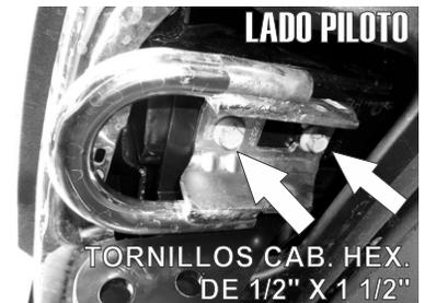
4.- Presente el Herraje Principal "A" por debajo del chasis y fíjelo con el segundo barrenos de la solera; utilizando uno de los tornillos que retiro con anterioridad.
