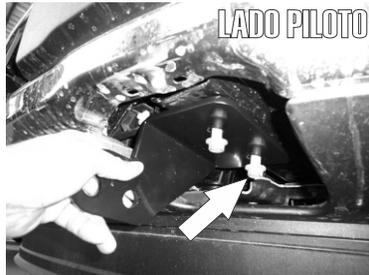
8.- Presente el Herraje Principal "A" por debajo del chasis y fijelo con el Herraje Auxiliar "B" insertado; utilizando los Tornillos de 1/2" X 1 1/2".
