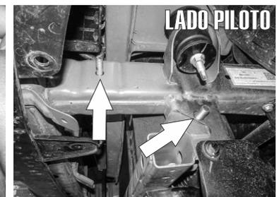
3.- Ahora por el barreno del soporte inferior, marcado en la primer imagen, deberá insertar el tornillo cabeza de coche de 1/2" X 1 1/2" junto con solera cuadrada con ayuda de una guía de micro-alambre, de tal forma que la que la rosca sobre salga a la parte externa del chasis.
