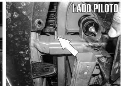
2.- Identifique el barreno lateral en el chasis del vehículo y pase de la parte interna hacia la externa del mismo, un tornillo hexagonal de 3/8" X 3 1/2" tal como se observa.
