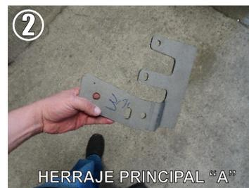
1.- Identifique por debajo del chasis los tornillos existentes y retirelos para poder colocar el Herraje Principal "A"
