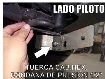
5.- Introduzca el **Tornillo Cab. Hex. 1/2" X 1 1/2"**, **Rondana Plana 1/2"** para lograr fijar el **Auxiliar "B"**, y finalice colocando **Rondana de Presión 1/2"** y **Tuerca Hexagonal de 1/2"**, sin ajustar en su totalidad el Herraje. Observe las imágenes para mayores referencias y repita el mismo procedimiento en el Lado Copiloto.
