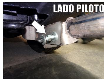
8.- Finalice colocando el Tornillo. Cab.Hex. de 1/2" x 1 1/2", Rondana Plana, de Presión y Tuerca Hex. de 1/2" en el segundo barreno y repita el mismo procedimiento en el Lado Copiloto.
