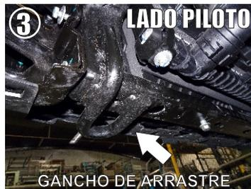
2.- Posicione el Herraje Principal "A" y guíe hacia los barrenos existentes, donde se ubicaban los tornillos existentes que retiro al inicio y que ahora le sirven para fijar los Herraje Principales.(Lado Copiloto/Piloto)
