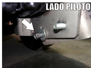
7.- Una vez colocado el **Auxiliar "B"**, proceda a presentar la **Burrera Alfa** colocando sus respectivos **Tornillo Cab. Hex 1/2" x 1 1/2"**. y del lado contrario **Rondana Plana, de Presión y Tuerca Hex 1/2"**, como se muestra en las imágenes.
