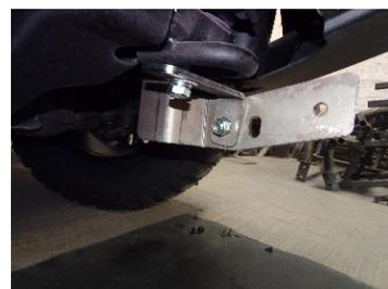
6.- Introduzca el **Tornillo Cab. Hex. 12 X 40 mm**, **Rondana Plana** y **de Presión de 1/2"** para lograr fijar el **Auxiliar "B"**, observe las imágenes para mayores referencias.
