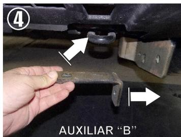
4.- Presente el **Herraje Auxiliar "B"**. Uno de los **Barrenos del Auxiliar "B"** debe estar posicionado al barreno existente que se ubica en medio del gancho de arrastre y el otro barreno debe estar posicionado al barreno del **Herraje Principal "A"**. Observe las imágenes para mejores referencias
