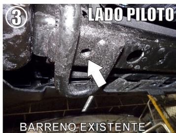
3.- En medio del gancho de arrastre existente observara un **barreno con rosca existente que le ayudara a fijar el Herraje Aux. "B"** tanto del Lado Piloto/Copiloto.
