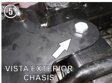
**5.-** Del otro lado coloque la tornillería faltante. **Rondana Plana, de Presión y Tuerca Hex. de 1/2"**
