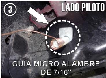
**3.-** Enrosque el **Tornillo Esp. Hex. c/Solera Pta-Cuad. 7/16" X 1 1/2"**, sobre la **Guía Micro Alambre**. Eh introduzca el Tornillo sobre el barreno Existente.
