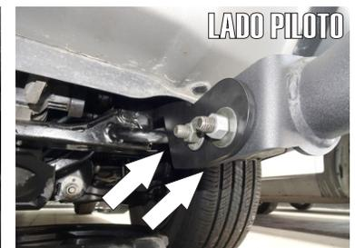
**6.-** Finalice Colocando la burrera y coloque los **Tornillo Cab. Hex. 1/2" X 1 1/2"**, **Rondana Plana, de Presión y Tuerca Hex. de 1/2"**
