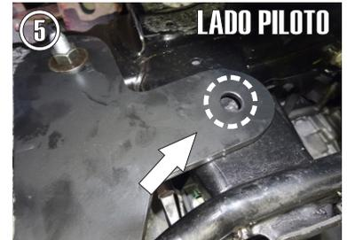
**5.-** En el segundo barreno coloque el **Tornillo Cab. Hex. 1/2" X 3 1/2"**.
