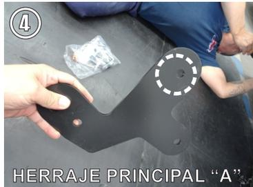
**4.-** Posicione el **Herraje Principal "A"**, sobre el Tornillo que coloco con la **Guía Micro-Alambre**, aun sin retirar la guía de la rosca del tornillo insertelo sobre el barreno del herraje. Una vez que posiciono el tornillo sobre el barreno, retire con cuidado la guía y coloque su tornillería- **Rondana Plana, de Presión y Tuerca Hex. 7/16"**
