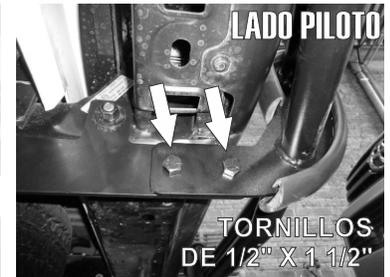
4.- Ahora retire la Guía y fije el Tornillo insertado con sus respectivas Rondanas y Tuerca de 1/2". Instale el Herraje del otro lado de la misma forma.
