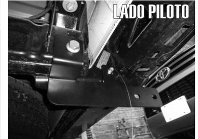
3.- Ahora presente el Herraje Principal "A" pasando la Guía por el segundo barreno y fijelo al chasis con el Tornillo retirado en el primer paso.
