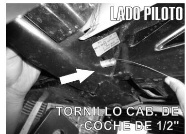
2.- Ahora inserte con Ayuda de la Guía de micro-alambre un Tornillo Cab. de Coche de 1/2" X 1 1/2" junto con una Solera Cuadrada de 2" X 1" de tal forma que salgan desde el barreno inferior hacia el lateral del chasis tal como se muestra en las imágenes.
