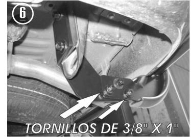
6.- Una vez instalados los Herrajes Principales "A" Lado Piloto y Lado copiloto, Presente la burrera por fuera de los los Herrajes y fijela con los tornillos de 3/8" X 1".
