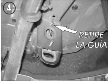
4.- Retire la guía manualmente y evite que los tornillos caigan dentro del soporte.
