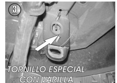
3.- Rosque la guía de micro-alambre con un tornillo especial de varilla soldada e inserte la guía del resaque central hacia el barreno superior, hasta que salga la punta del tornillo.
