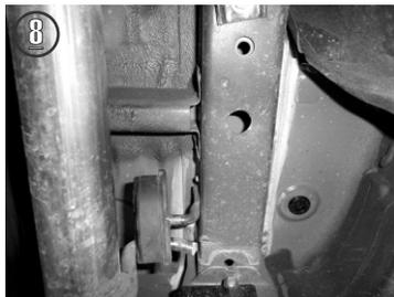
8.- Inserte en el barreno inferior aledaño al soporte por la parte de abajo del chasis un Tornillo Esp. "T" Desbastado de 3/8" dejando la rosca hacia afuera tal como se muestra en las imágenes.
