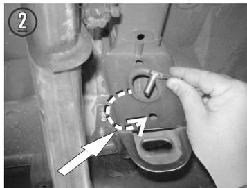
2.- Inserte manualmente un tornillo especial con varilla soldada, del resaque central del soporte hacia el barreno inferior.
