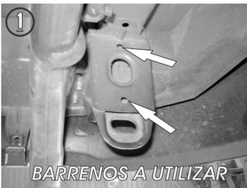
1.- Identifique los barrenos ubicados en el soporte posterior de la carrocería.
