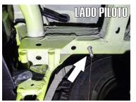
1.- Primeramente ubique el barreno existente en la parte inferior del chasis lateral trasero del auto y proceda a insertar un tornillo especial con varilla de 3/8" junto con una solera. Use una guía de micro-alambre para pasarlos desde la parte interna a la defensa y deje la rosca hacia abajo en el barreno señalado, tal como se observa en las imágenes.
