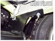
4.- Use un Tornillo de 3/8" X 4" junto con una rondana y una solera cuadrada, paselo de lado a lado del chasis y fijelo al barreno lateral del herraje. NOTA; Meta una solera cuadrada entre la cara del chasis y la placa del Hitch a manera de calza para evitar el juego.
