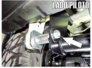
5.- Con un Tornillo de 1/2" X 4" sujete el herraje al gancho de arrastre del vehiculo, colocando una solera cuadrada y un tubo de 3/4" X 4.5cm a modo de calza con la pared externa del herraje.
