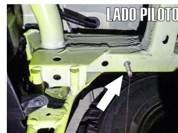
4.- Posteriormente ubique el barreno existente en la parte inferior del chasis lateral trasero del auto y proceda a insertar un tornillo especial con varilla de 3/8" junto con una solera. Use una guía de micro-alambre para pasarlos desde la parte interna a la defensa y deje la rosca hacia abajo en el barreno señalado, tal como se observa en las imágenes.
