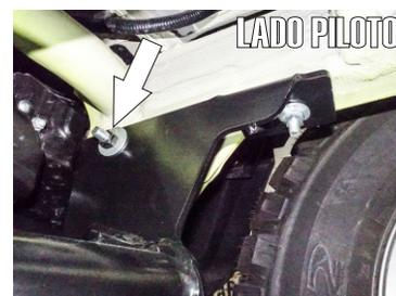
6.- Use un Tornillo de 3/8" X 4" junto con una rondana y una solera cuadrada, paselo de lado a lado del chasis y fíjelo al barreno lateral del herraje. **NOTA; Meta una solera cuadrada entre la cara del chasis y la placa del Hitch a manera de calza para evitar el juego.**
