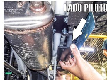
3.- Ahora fije el **Herraje Auxiliar "B"** al travesaño tubular usando las abrazaderas previamente insertadas, con las tuercas y rondanas de 3/8". Al final centre el herraje, justo en el corte que realizo en el primer paso.
