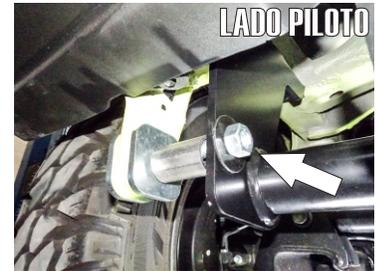
7.- Con un Tornillo de 1/2" X 4" sujete el herraje al gancho de arrastre del vehiculo, colocando una solera cuadrada y un tubo de 3/4" X 4.5cm a modo de calza con la pared externa del herraje.
