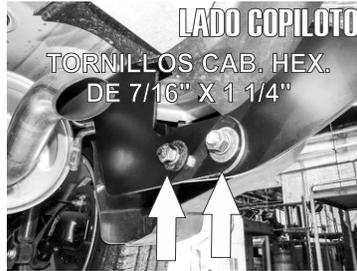
4.- Finalmente mote el Bumper Trasero a los Herrajes instalador usando los tornillos de 7/16 X 1 1/4".
