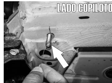
1.- Primeramente ubique el barreno existente en la parte inferior del chasis trasero del auto y proceda a insertar un tornillo especial con varilla de 3/8" junto con una solera. Use una guía de micro-alambre para meterlos y dejar por la parte externa la rosca del tornillo hacia abajo, tal como se observa en las imágenes.
