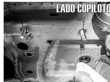
2.- De igual manera ubique el otro barreno existente en la parte inferior del chasis trasero del auto y proceda a insertar un tornillo especial con varilla de 3/8" junto con una solera. Use una guía de micro-alambre para meterlos y dejar por la parte externa la rosca del tornillo hacia abajo, tal como se observa en las imágenes.
