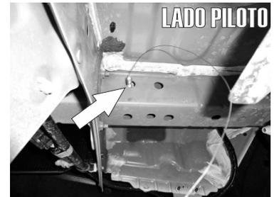
4.- De lado piloto del vehículo ubique los barrenos que se encuentran en el chasis y con ayuda de una Guía de Micro-Alambre introduzca un Tornillo Esp. "T" de 3/8" X 1 1/4" y una solera redondeada del barreno inferior al superior lateral tal como se muestra en las imágenes.
