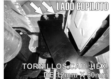
1.- Por debajo del vehículo de lado copiloto ubique los dos tornillos que sujetan el gancho y proceda a retirarlos.
