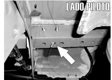
5.- De igual manera introduzca otro Tornillo Esp. "T" de 3/8" X 1 1/4" con ayuda de la Guía de Micro-Alambre sacándolo en el otro barreno.
