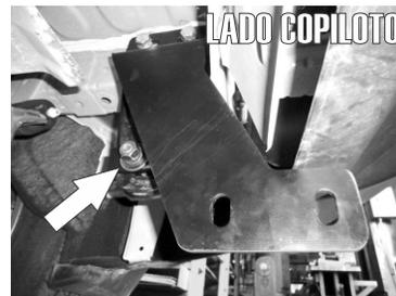
3.- Usando un Tornillo de 1/2" X 2" y una solera cuadrada de 5X5cm termine de fijar el Herraje al gancho con el barreno inferior.
