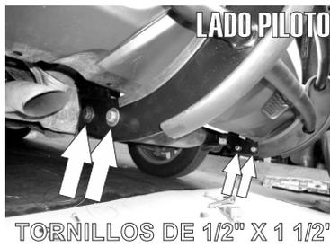
8.- Una vez instalados los Herrajes Principales "A" presente el Bumper y fíjelo por la parte externa con los Tornillos Cab. Hex. de 1/2" X 1 1/2" con sus respectivas Rondanas y Tuercas de 1/2".
