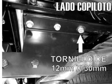
3.- De lado Copiloto deberá introducir los Tornillos existentes del Gancho anteriormente retirado más un Tornillo Hex. de 12mm X 30mm en los barreno del chasis.
