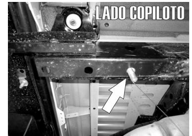
4.- Si la versión de su vehículo no cuenta con los barrenos roscados de Lado Copiloto deberá introducir los Tornillos Cab. Coche de 1/2" X 1 1/2" junto con las soleras rectangulares ayudandose de las Guías de Micro-Alambre (Adjuntas en la Kit de Tornilleria del producto) empezando por el barreno más alejado tal como se muestra en las imágenes.
