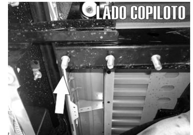
5.- Continúe insertando los otros Tornillos Cab. Coche de 1/2" X 1 1/2" junto con las soleras rectangulares ayudandose de las Guías de Micro-Alambre (Adjuntas en la Kit de Tornilleria del producto) en los dos barrenos restantes.
