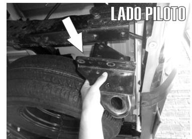
1.- Primeramente Identifique el Gancho justo debajo del chasis de Lado Piloto por la parte trasera del Vehículo y proceda a retirarlo quitando tanto los dos Tornillos inferiores como los tres que se encuentran en la parte lateral interna del mismo.
