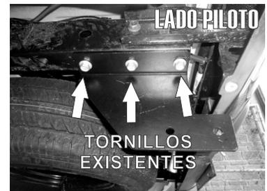
2.- Una vez quitado el gancho proceda a montar el Herraje Principal "A" justo en los tres barrenos despejados del chasis donde iba el mismo gancho utilizando los Tornillos existentes previamente retirados.
