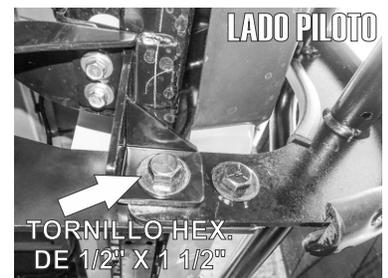
6.- Ya retirados los tornillos existentes fíje en ese lugar el **Herraje Auxiliar "B"**, usando los tornillos de 8mm X 30mm. Finalmente fíje al barreno posterior del **Herraje Principal "A"**, usando los **Tornillos Hex.** de 1/2" X 1 1/2" como se muestra en las imágenes.
