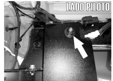
4.- Por la parte interna introduzca una vez más un **Tornillo Cab. Coche** junto con una solera rectangular sacando de manera lateral en dirección del barreno existente en el **Herraje** y fíjelo a este.
