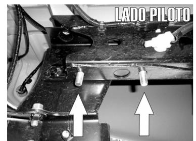
2.-Inserte manualmente otro tornillo Cab. Coche junto con una solera rectangular en el segundo barreno aledaño dejando la rosaca hacia abajo.
