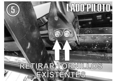
5.- Presente el **Bumper Trasero** y fíje al primer barreno del **Herraje Principal "A"** usando el **Tornillo Cab. Hex.** de 1/2" X 1 1/2".
