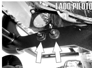
6.- Entre los dos **Herrajes** previamente instalados inserte el **Bumper Trasero** y fíjelo a estos a modo de sandwich con los **Tornillos Cab. Hex. de 1/2"**.
