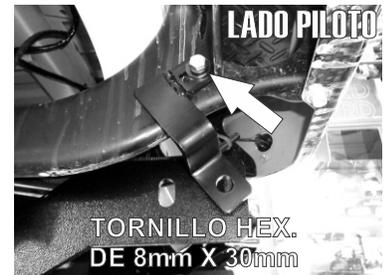
5.- De lado lateral externo de los soporte para la defensa ubique el tornillo marcado y retirelo para poder fijar en ese lugar el **Herraje Auxiliar "B"** alineándolo al barreno del **Herraje Principal "A"** como se muestra en las imágenes.
