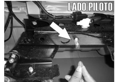
1.- Identifique los barrenos existentes por debajo del chasis en la parte trasera del vehículo y proceda a insertar un Tornillo Cab. Coche junto con una solera rectangular ayudandose de la guía de micro-alambre incluida en el Kit pasandola del barreno posterior señalado.
