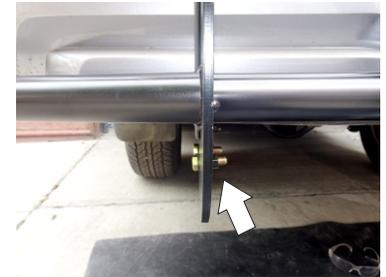
5.- Finalice colocando las **Rondanas Planas, de Presión y Tuerca de 1/2"** para fijar el **Bumper Trasero Bronco**.
