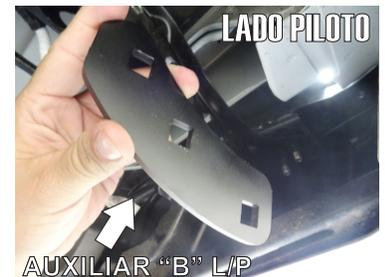
1.- Identifique los barrenos existentes por debajo del chasis en la parte trasera del vehículo. (Lado piloto/copiloto) Proceda a colocar el Auxiliar "B" Sobre el brazo del chasis.
