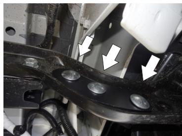
2.- Una vez colocado el Auxiliar "B", proceda a insertar sobre los barrenos del auxiliar los Tornillo Cab. Coche de 1/2" X 1 1/2" y fije Como se observa en las imágenes, esto también aplica lado copiloto.
