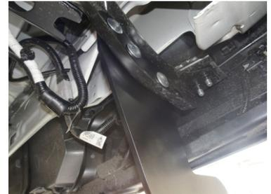
3.- Con cuidado presente el **Herraje Principal "A"** sobre las roscas de los tornillos que coloco con anterioridad y fije utilizando las **Rondanas Planas, de Presión y las Tuercas Hexagonales de 1/2"** haciendo un tipo sandwich.
