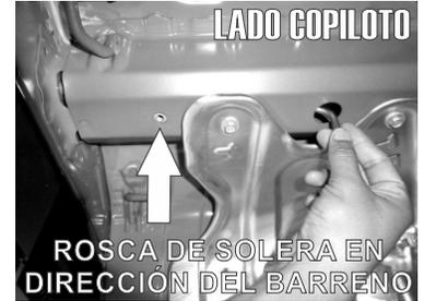
3.- Ahora Introduzca sobre los barrenos superiores del chasis una **Varilla Especial con Solera Soldada** dejando la rosca en dirección del barreno posterior tal como se muestra en las imágenes superiores
