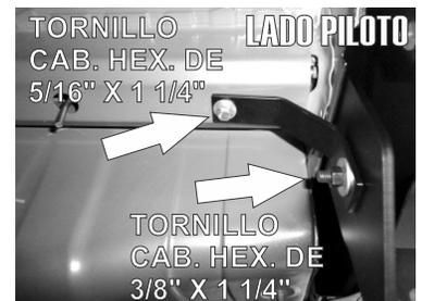
6.- Ponga de igual forma que los Herrajes de Lado Copiloto poniendo Primeramente el **Herraje Pricipal "A"** con los Tornillos de 8mm X 30mm entre el chasis y la defensa y después introduciendo una **Varilla Especial con Solera Soldada** dejando la rosca en dirección del barreno para poner el **Herraje Auxiliar "B"** fijandolo al chasis con un Tornillo de 5/16" X 1 1/4" y un Tornillo Cab. Hex. de 3/8" X 1 1/4" para fijarlo con el Herraje.
