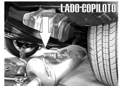
1.- De Lado Copiloto del Vehículo deberá bajar el Mofle para poder instalar el Herraje desgancho los agarres de goma que tiene a cada lado y bajandolo con cuidado para no dañarlo.
