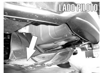
5.- Para instalar los Herrajes de Lado Piloto del Vehículo deberá abrir un poco la Tolva plástica existente retirando las grapas y tornillos señalados en las imágenes.
