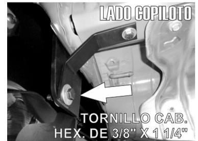
4.- Refuerce el Herraje Principal poniendo el **Herraje Auxiliar "B"** a modo de escuadra sujetandose con un Tornillo Cab. Hex. de 5/16" X 1 1/4" del lado superior con la solera puesta y un Tornillo Cab. Hex. de 3/8" X 1 1/4" para fijarlo en la parte inferior del Herraje.
