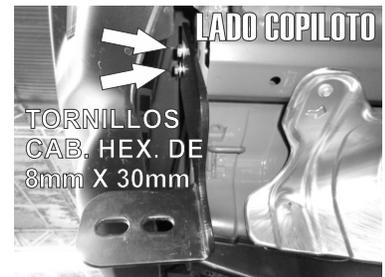
2.- Una vez quitado el mofle presente el **Herraje Principal "A"** en la parte posterior entre el chasis y la defensa y fijelo a los dos barrenos existentes con los Tornillos Cab. Hex. de 8mm X 30mm tal como se muestra.
