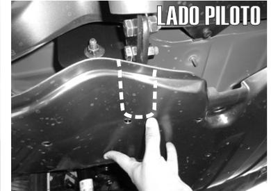
7.- Teniendo ya los herrajes puestos de lado Piloto y Copiloto presente la Burrera por la parte exterior de los mismos y sujetela con los Tornillos Cab. Hex. de 7/16" X 1 1/2".
