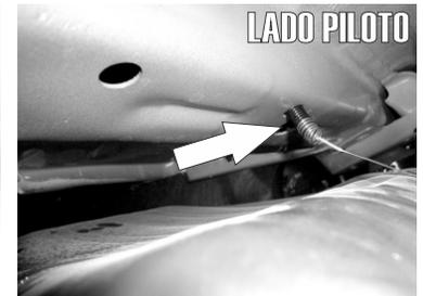
2.- Identifique los barrenos señalados y con ayuda de la guía de micro alambre inserte un Tornillo Esp. "T" de 7/16 X 1 1/4" pasandolo desde el barreno más amplio hacia el de menor tamaño que se encuentra en la parte posterior de estos.
