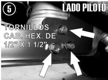
5.- Finalmente monte el Bumper por la parte interna de los Herrajes usando los Tornillos de 1/2" X 1 1/2"
