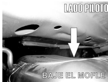
1.- Por la parte trasera inferior ubique el mofle y retire el gancho que lo sujeta para poder bajarlo un poco y descubrir los barrenos en el Chasis justo encima.
