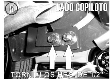
4.- Por la parte interna de este fije el **Herraje Auxiliar "B"** en el tornillo previamente insertado de 3/8" dejando alineados los barrenos inferiores de ambos herrajes tal como se muestra.
