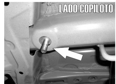
1.- Identifique por la parte trasera inferior del chasis el barreno existente e inserte manualmente un tornillo "T" de 7/16" X 1 1/2" con solera dejando la rosca en la parte inferior tal como se observa en las imágenes.
