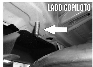
2.- Por la parte posterior de la defensa, a un lado del tornillo insertado en el paso anterior, ubique los barrenos existentes y proceda a introducir un tornillo esp. con varilla de 3/8" con ayuda de una guía de micro-alambre pasandolo del barreno de mayor diámetro al menor.
