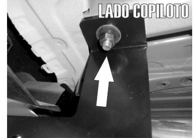
3.- Una vez introducidos ambos tornillos, presente el **Herraje Principal "A"** y fíjelo al tornillo de 7/16" usando sus respectivas tuercas y rondanas.
