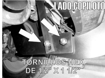
7.- Finalmente monte el Bumper a los Herrajes instalados usando los Tornillos de 1/2" X 1 1/2" tal como se observa.
