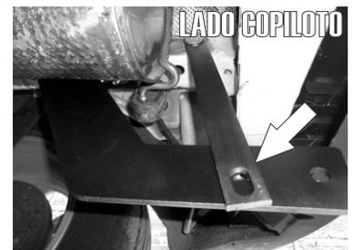
6.- Por la parte lateral del Chasis, por la parte interna, ubique un tornillo roscado existente y en este fije el Herraje Auxiliar "B" utilizando un Tornillo de 10mm X 30mm, dejando el barreno inferior alineado al barreno posterior del Herraje Principal "A". Instale los Herrajes de Lado Piloto de la misma forma.
