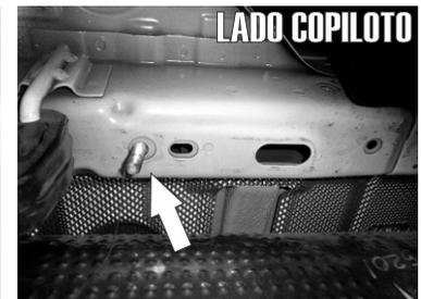
1.- Identifique los barrenos existentes en la parte inferior del chasis de la parte trasera del auto, justo por encima del mofle y proceda a insertar, con ayuda de la guía de micro alambre, un Tornillo Esp de 3/8" X 1 1/4" con Varilla, pasandolo, del barreno en forma de galuz al redondo del final.
