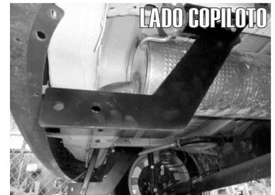
5.- Fije el Herraje a los tornillos utilizando las tuercas y rondanas correspondientes a cada tornillo. Usando las de 7/16" para el primer tornillo de adelante hacia atrás del vehículo, de 3/8" para el tercero y 5/16" para el segundo respectivamente.
