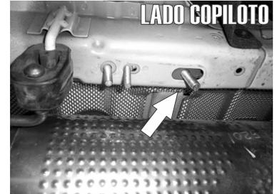
3.- Inserte una vez más, con ayuda de la guía de micro alambre, un Tornillo Esp de 7/16" X 1 1/2" junto con una Solera para Tornillo, dejando hacia abajo la rosca tal como se observa en las imágenes.
