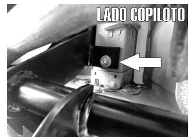
6.- De la misma manera por el Lado Copiloto fije el Herraje Principal "A" con ayuda de las Guía de Micro-Alambre montandolo en los tornillos insertados del Lado Piloto del Vehículo. Fijelos con las Tuercas y Rondanas de 3/8".
