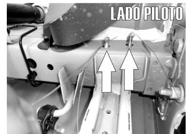
2.- De igual forma inserte un Tornillo Esp. "T" Cab. Hex. de 3/8" X 1 1/2" junto con una Solera para Tornillo en el barreno posterior marcado.
