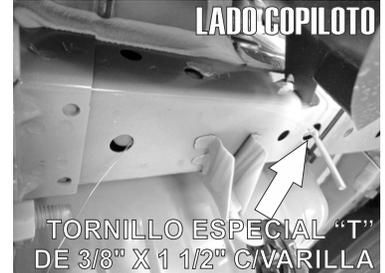
3.- Por el Lado Copiloto del Vehículo Identifique los barrenos existentes por debajo de la carrocería e introduzca manualmente un Tornillo Esp. "T" Cab. Hex. de 3/8" X 1 1/2" junto con una Solera para Tornillo.
