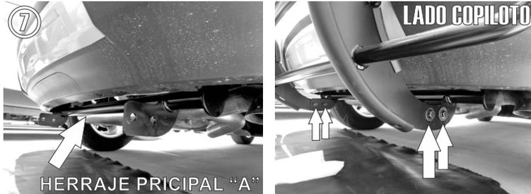
7.- Una vez instalado el **Herraje Principal "A"** presente el Bumper y fijelo con los Tornillos Cab. Hex. de 1/2" X 1 1/2" con sus respectivas Rondanas y Tuercas de 1/2".
