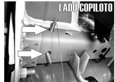
4.- De igual forma inserte un Tornillo Esp. "T" Cab. Hex. de 3/8" X 1 1/2" junto con una Solera para Tornillo en el barreno posterior marcado.
