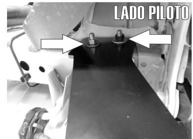
5.- Presente el Herraje Principal "A" y con ayuda de las Guía de Micro-Alambre montelo en los tornillos insertados del Lado Piloto del Vehículo. Fijelos con las Tuercas y Rondanas de 3/8".
