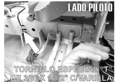
1.- Por el Lado Piloto del Vehículo Identifique los barrenos existentes por debajo de la carrocería e introduzca manualmente un Tornillo Esp. "T" Cab. Hex. de 3/8" X 1 1/2" junto con una Solera para Tornillo en orificio marcado.
