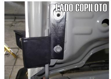
2.- Retire solo un Tornillo y presente la BASE DOBLE, verificando que coincidan con los tornillos de la bisagra.
