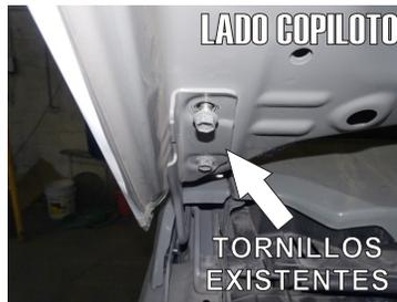
1.- Levante el cofre del vehículo y ubique los dos tornillos que fijan las bisagras.
