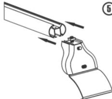
Deslice la base armada sobre las ranuras del perfil de aluminio.
