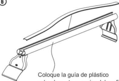
Coloque la guía de plástico sobre la parte superior del perfil.
