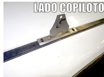
6. Después de barrenar la moldura de plástico tanto la parte delantera como la parte de atrás ya sea Lado Copiloto/Piloto. proceda a colocar la Solera en el interior del canal como se muestra en las imágenes.
