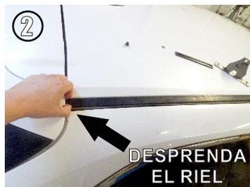
2.- Con un desarmador plano o manualmente desprenda la moldura de plástico tanto Lado Piloto/Copiloto.
