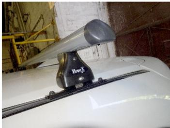
9. Ahora comience fijando los Tornillos con la Llave Allén Correspondiente y replique la misma fijación en el resto de los ganchos. Finalice fijando la Barra y Base con su Tornillería correspondiente.
