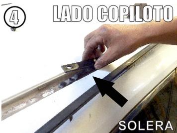
4.- Presente la Solera que le ayudara a fijar el gancho. Después marque sobre la moldura de plástico los centros para barrenar. NOTA: Realice el mismo procedimiento en la moldura del piloto. recuerde que son dos soportes por lado Piloto/Copiloto.
