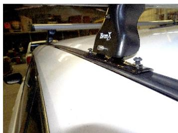
8. En este punto coloque la base con la barra sin ajustar la tornillería, solamente coloque los Torn. Botón Allén 6mmX20mm, Rondana Plana y de Presión 1/4" para fijar el Gancho al Toldo.
